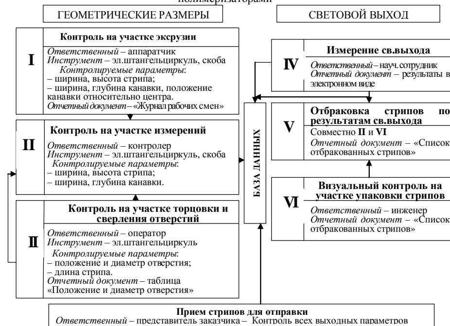
Рис. 4 – Система производственного контроля качества ПС стрипов
