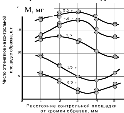
Рис. 1. Зависимость критерия производительности обработки от единичной массы обрабатываемых деталей: \Delta – число отпечатков на торцах образцов; O – на плоскостях тех же образцов.
