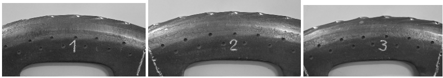
Рисунок 2 – Загальний вигляд секторів диска після напрацювання 240 га з параметрами: а) – t_3 = 35 мм, h_3 = 2 мм; б) – t_3 = 35 мм, h_3 = 2,5 мм; в) – t_3 = 35 мм, h_3 = 3 мм
