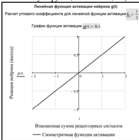
Рисунок 2 – График симметричной линейной функции активации
