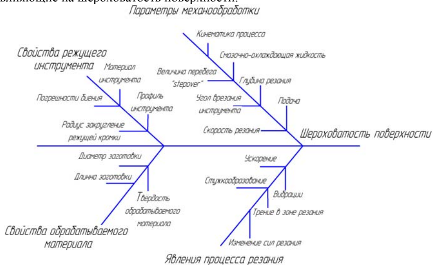
Рис. 5 – Параметры, влияющие на шероховатость поверхности
