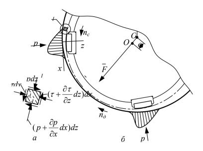
Рис.2 Схема образования гидродинамического давления: a — элементарный объём СОЖ,  $\delta$  — эпюра гидродинамического давления
