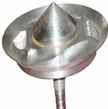
Рисунок 3 – Сопловой аппарат – дно рабочей емкости.
