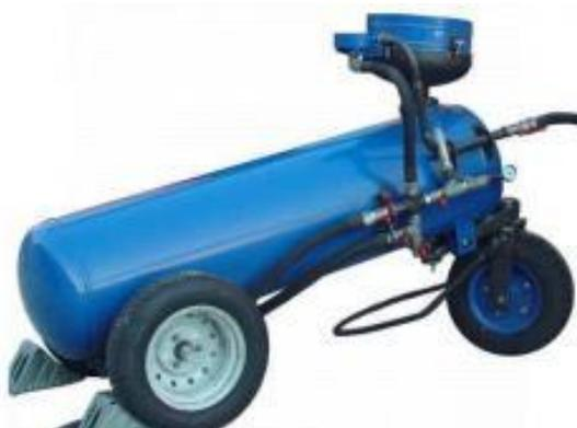
Рисунок 1 – Установка для струйно-абразивной обработки деталей с использованием давления сжатого воздуха до 2 МПа
