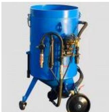
Рисунок 2 – Установка для струйно-абразивной обработки деталей с использованием давления сжатого воздуха до 0,6 МПа
