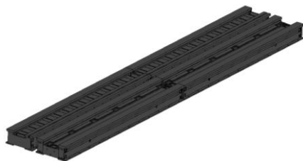
Рисунок 3 – Твердотельная модель станины тяжелого токарного станка
