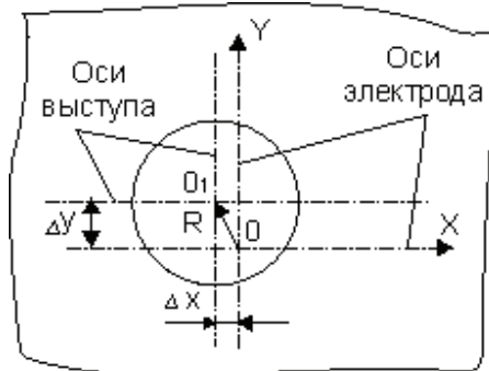
Рис. 2. Отклонение центра наплавленного выступа
