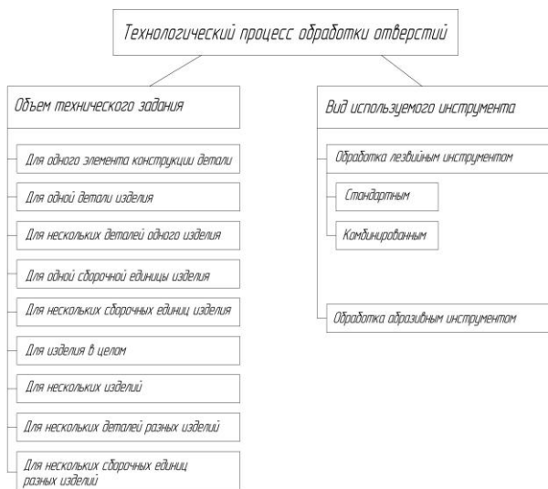
Рис. 1 – Некоторые начальные условия для разработки вариантов структуры технологического процесса обработки отверстий с применением КОИ
