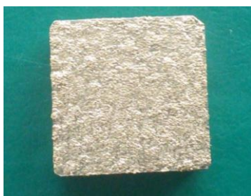
Рис. 6 – Образец стали 20 после ЭЭЛ оловянной бронзой
