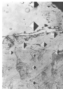
Рисунок 4 – Структура баббитового покрытия с медным подслоем на образце из стали 20, X 400.
