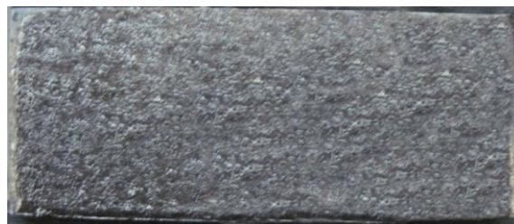
Рис. 3 – Плоский образец стали 20 после ЭЭЛ медью и баббитом
