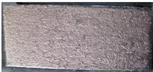
Рис. 2 – Образец стали 20 после ЭЭЛ медью
