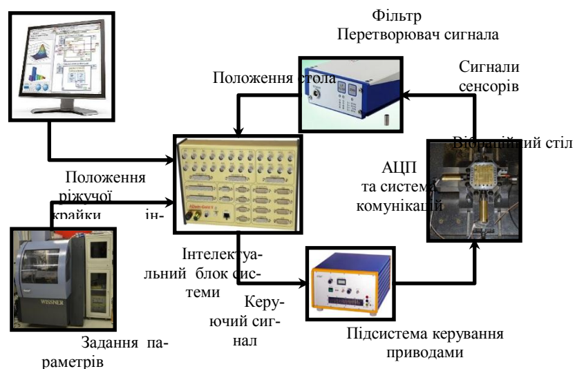
Рис. 4 - Блок схема системи керування приводами переміщення двохкоординатного стола
