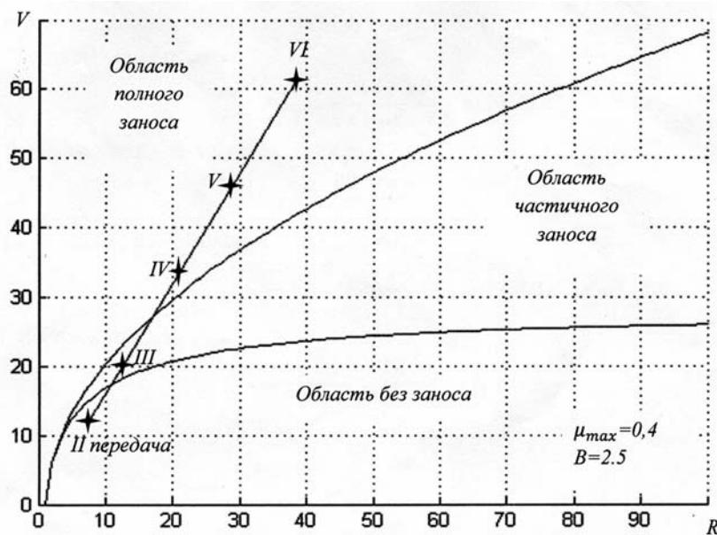
Рис. 5 – Зависимость скорости от радиуса поворота при  $\mu_{\max} = 0,4$
