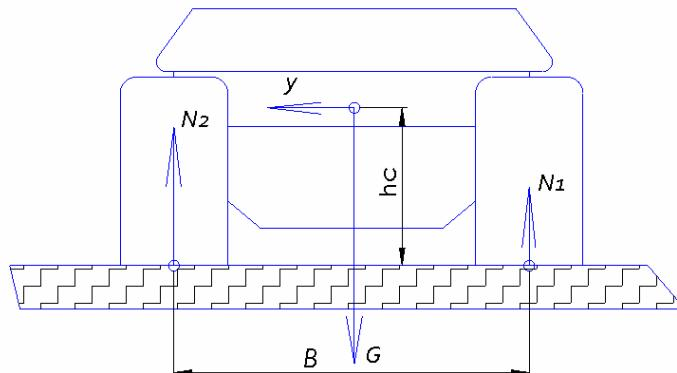
Рис. 2 – Распределение нагрузок по гусеницам под действием  $F_C$
