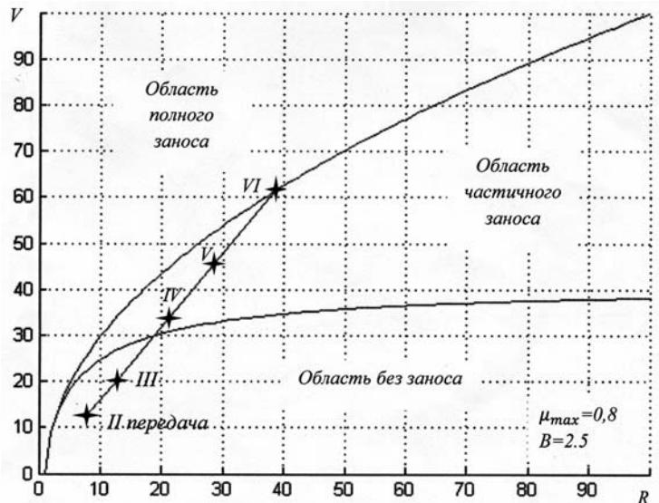
Рис. 3 – Зависимость скорости от радиуса поворота при  $\mu_{\max} = 0,8$
