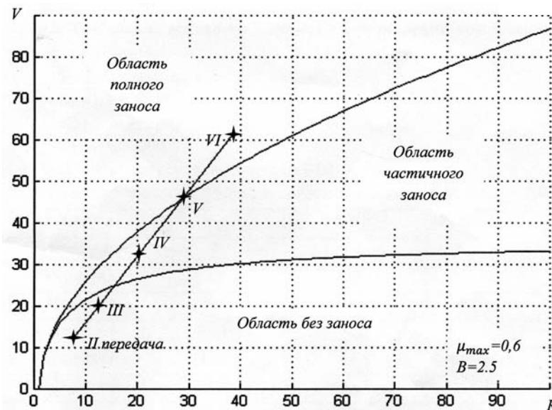
Рис. 4 – Зависимость скорости от радиуса поворота при  $\mu_{\max} = 0,6$
