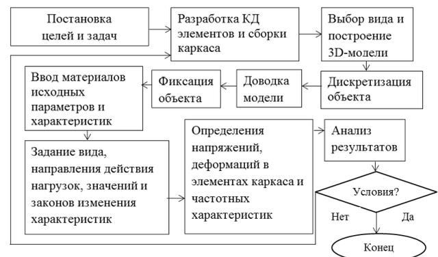
Рис. 9. – Блок-схема алгоритма исследования НДС каркаса кабины МКЭ
