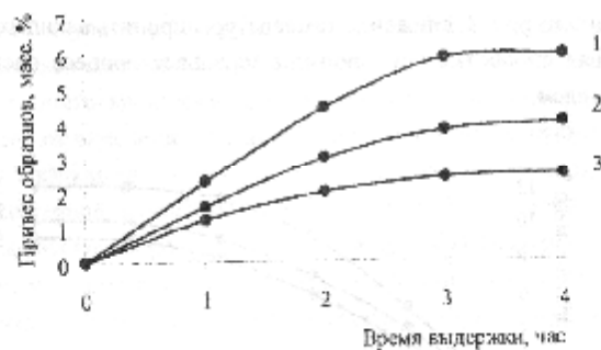
Рис. 1. Зависимость привеса образцов от состава пропитываемой композиции и времени выдержки в ней: 1 – ЭТС-32/80; 2 – ЭТС-32/80 : \text{H}_2\text{O} = 2 : 1; 3 – ЭТС-32/60. Количество катализатора \text{HNO}_3 – 0,1 %.
