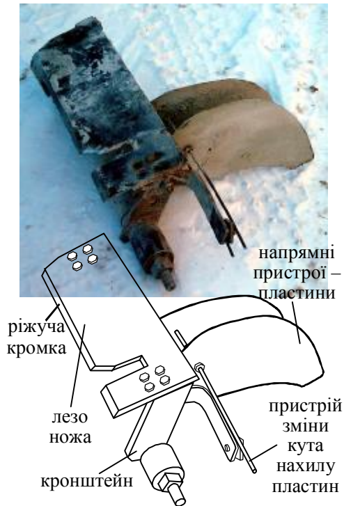
Рис. 19. Вузол ножа та напрямних пристроїв для переміщення матеріалу вздовж барабану (для зміни висоти матеріалу під валком)
