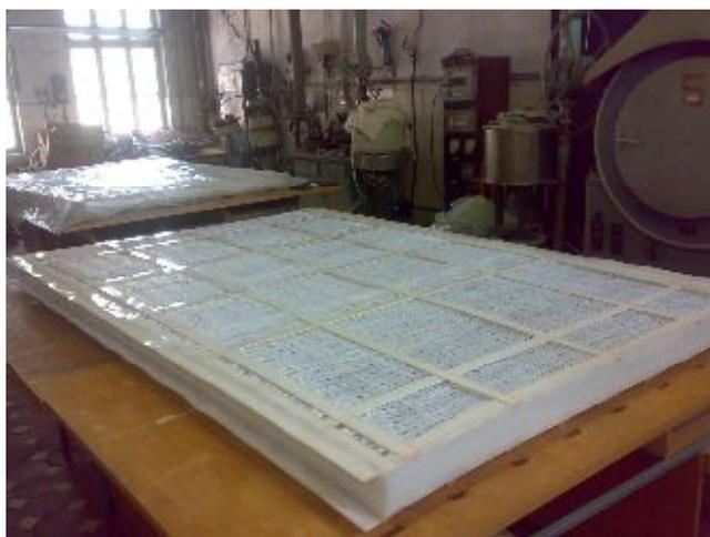
Рис. 5. Каплеотбойник фторопластовый
