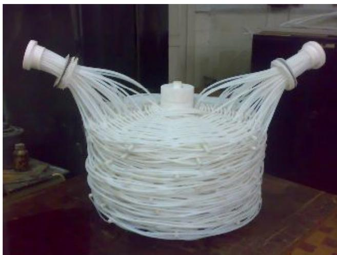
Рис. 4. Фторопластовый теплообменник погружного типа
