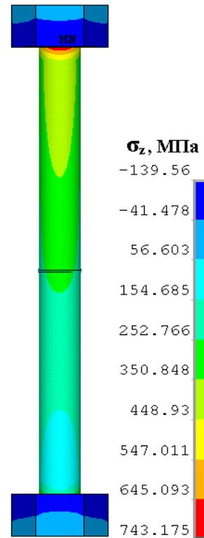
Рис. 11. Осевые напряжения в шпильке в рабочем режиме
