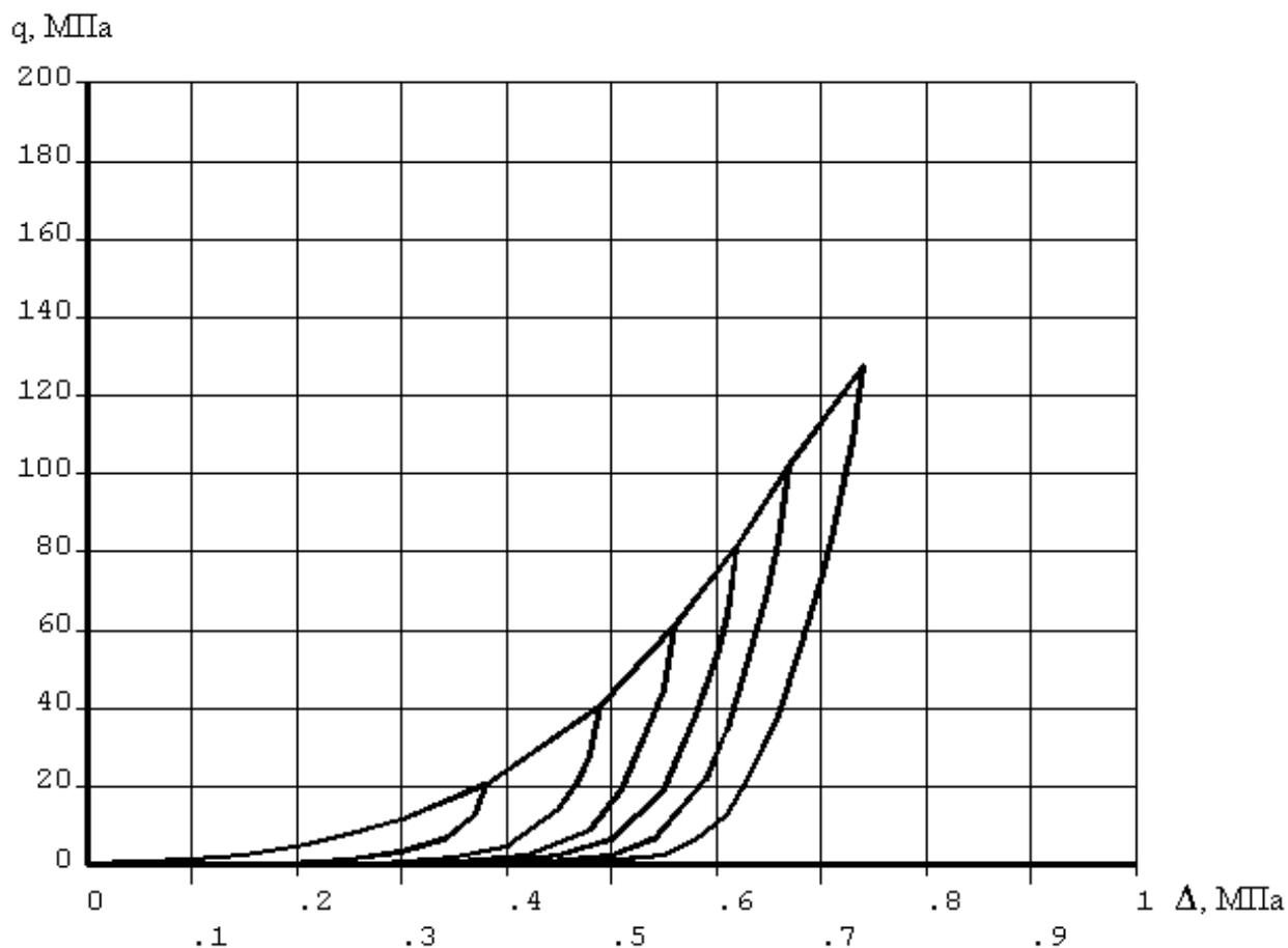
Рис. 2. Диаграмма деформирования паронитовой прокладки
