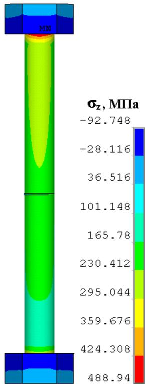
Рис. 10. Осевые напряжения в шпильке при монтаже
