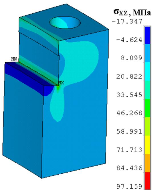
Рис. 8. Напряжения среза в полукольце при монтаже
