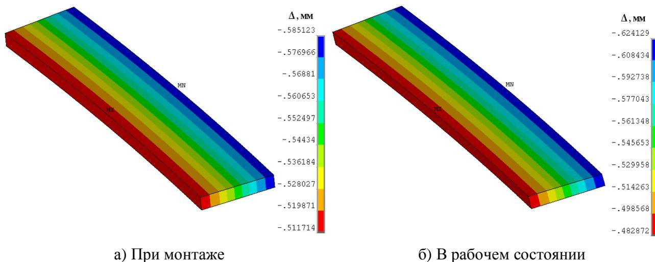
Рис. 4. Деформации прокладки
