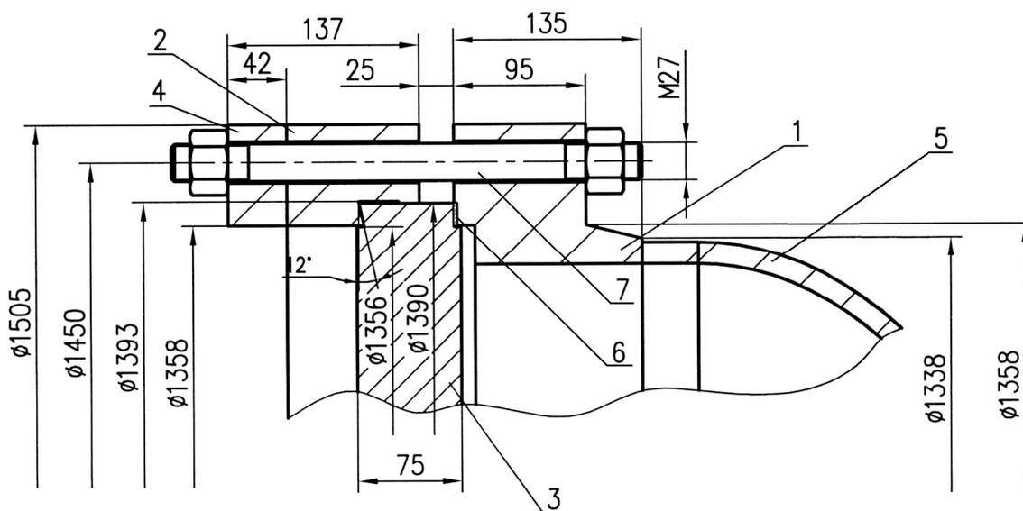
Рис. 1. Конструкция фланцевого соединения плавающей головки
