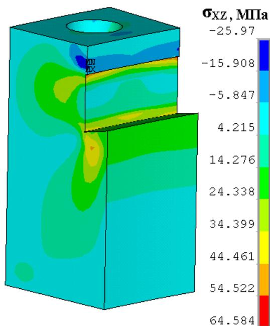
Рис. 9. Напряжения среза в полукольце. Рабочий режим
