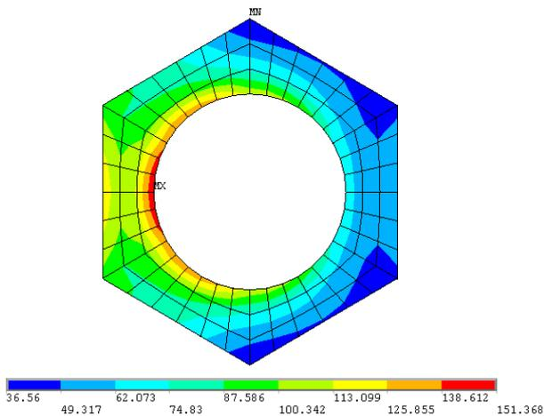
Рис. 13. Контактное давление между контактными парами гайка – фланцевое кольцо
