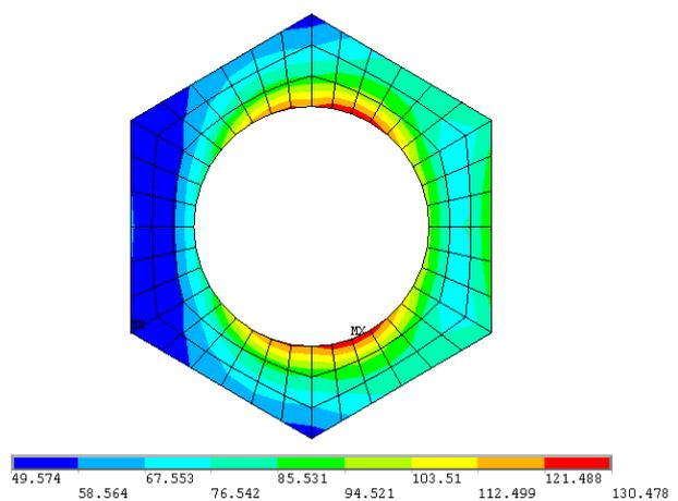
Рис. 14. Контактное давление между контактными парами гайка – полукольцо
