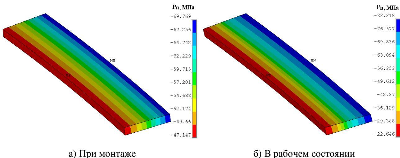
Рис. 5. Контактное давление на прокладки
