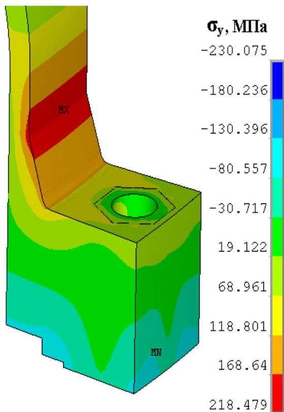
Рис. 6. Распределение окружных напряжений во фланцевом кольце в рабочем режиме
