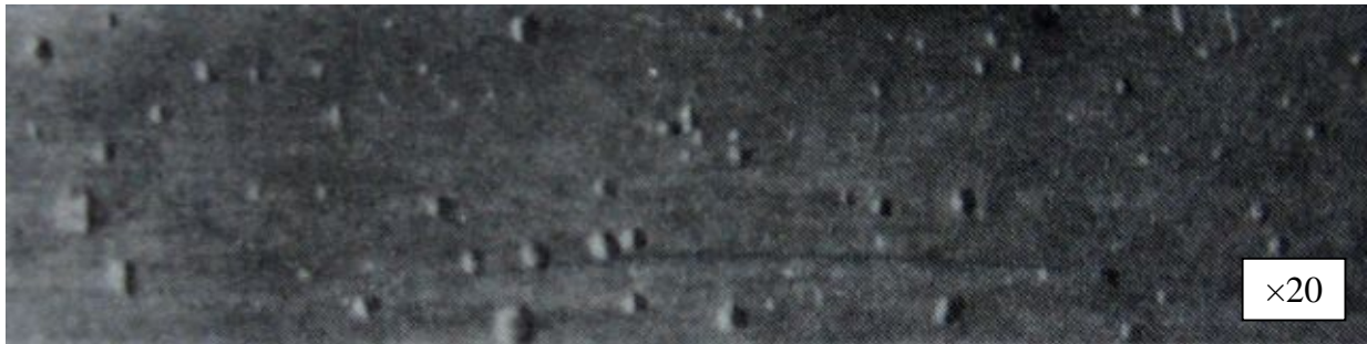
Рис. 1. Внешний вид образца сплава ХН60МБ после промышленных испытаний
