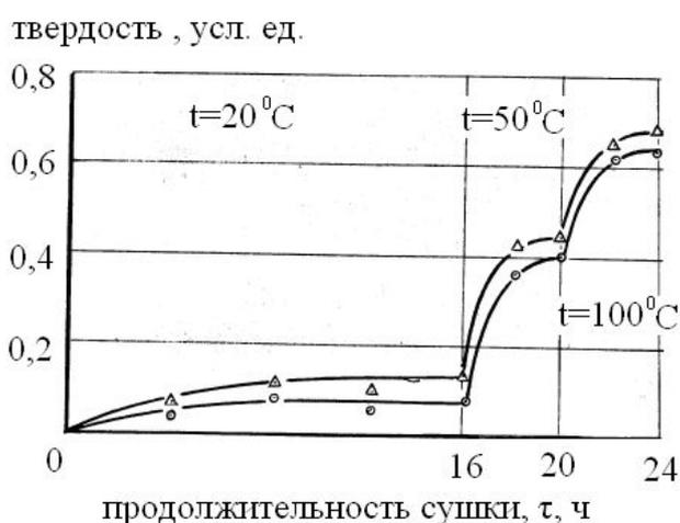
Рис. 3. Изменение твердости пленок на основе эпоксидной смолы ЭД-20 в зависимости от температуры ( $t$ , °C) и продолжительности ( $\tau$ , ч) сушки:
