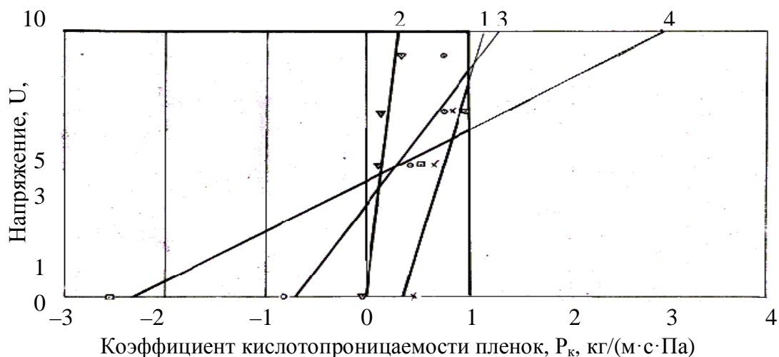
Рис. 8. Исследование проницаемости уксусной кислоты \text{CH}_3\text{COOH} : 1 – лаковая пленка; 2 – эмалевая; 3 – лаковая с содержанием катионита КУ 2-8чС в \text{H}^+ форме; 4 – лаковая с содержанием катионита КУ 2-8чС в \text{Ca}^{2+} форме.
