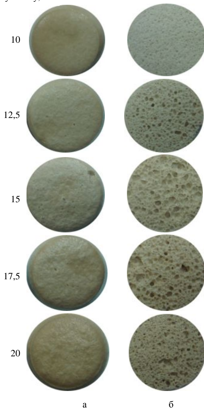
Рис. 4 – Зовнішній вигляд (а) та горизонтальний переріз (б) зразків, випалених при 750 °С
