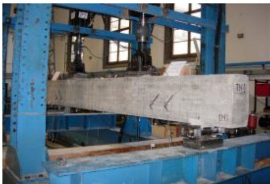
Рис. 3 – Установка для испытания на изгиб железобетонных конструкций
