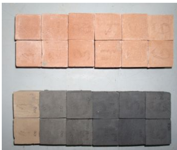
Рис. 7 – Випробувані зразки до і після випалу
