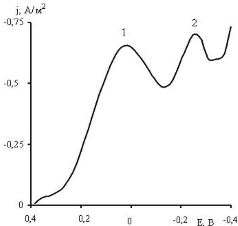
Рис. 1 – Линейная вольтамперограмма на Pt электроде, pH 10,  $s = 0,05$  В/с. Состав раствора моль/дм<sup>3</sup>:  $c(\text{Pd(II)}) - 1 \cdot 10^{-2}$ ,  $c(\text{K}_4\text{P}_2\text{O}_7) - 5 \cdot 10^{-1}$ ,  $c(\text{KCl}) - 1,0$ .
