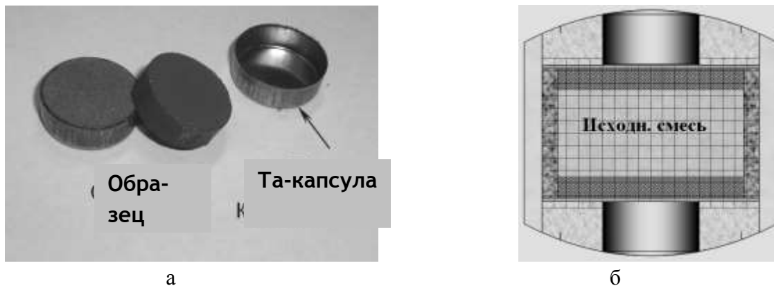
Рис. 2 – Внешний вид смеси: а – в защитной Та-капсуле, б – размещение образца в ячейке высокого давления перед проведением экспериментов.
