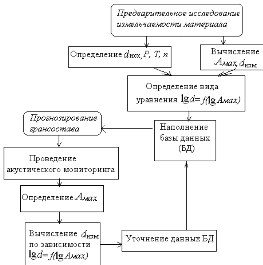
Рис. 8 – Блок-схема методики прогнозирования гранулометрического состава материала в процессе измельчения или пневмотранспортирования
