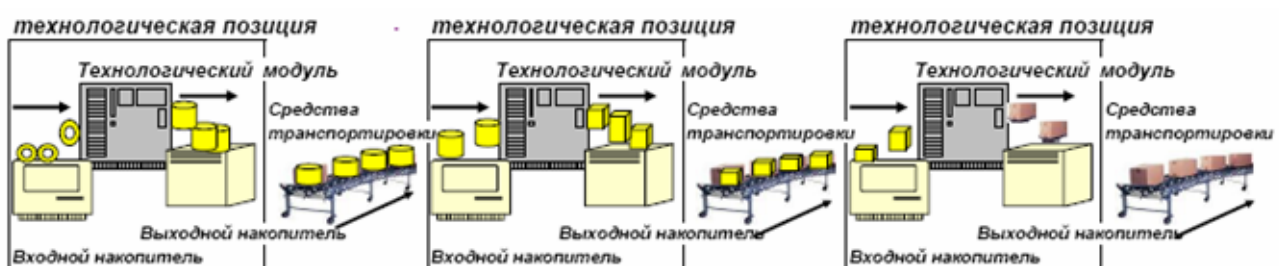
Рис.1. Структура поточной технологической линии
