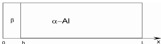
Рис. 1 Схема, поясняющая задачу диффузии цинка из интерметаллида \beta
