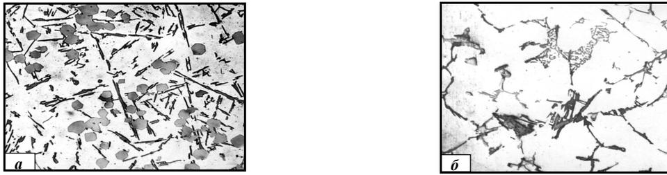
Рис. 1. Микроструктура ( $\times 200$ ) ЛКМ системы [Al – FeCr] (а) и базового сплава АК12 ГОСТ 1583-93 (б)
