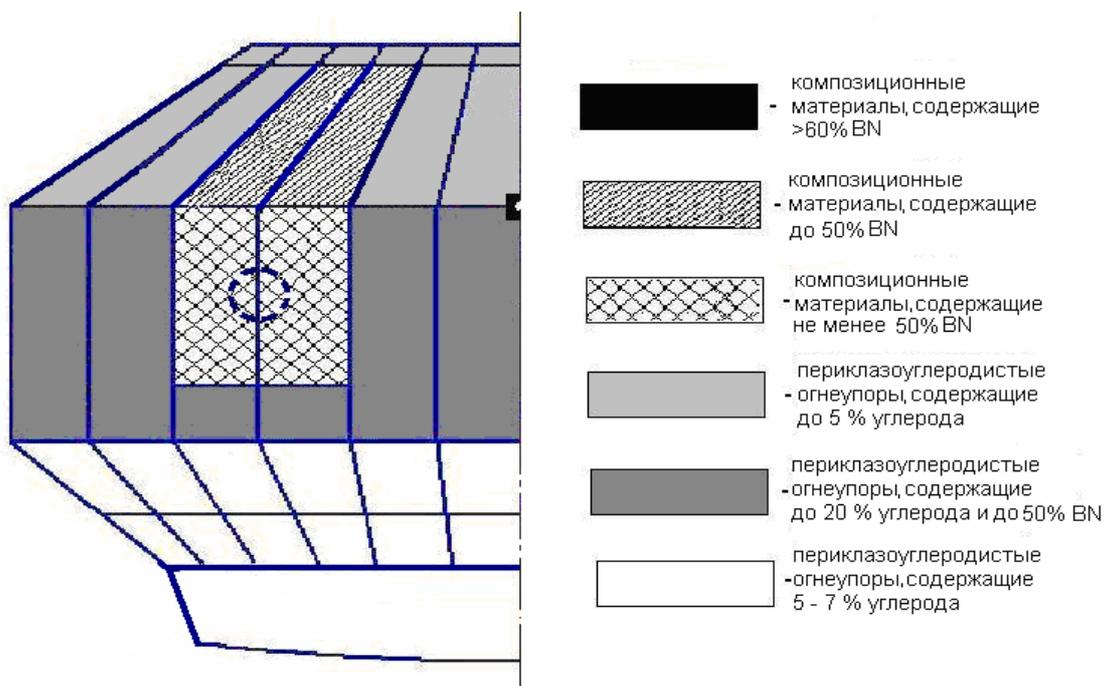
Рис. Модель дизайна рабочего слоя высокостойкой футеровки кислородного конвертера с использованием композиционных огнеупоров
