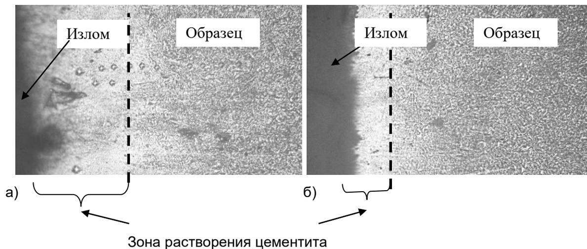
Рис. 1 – Микроструктура сталей без (а) и с дисперсионным нитридным упрочнением (б) (x400)
