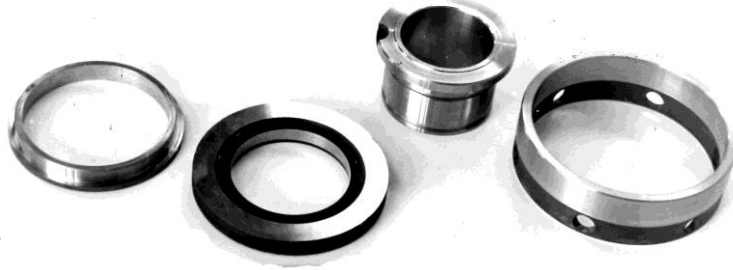
Рис. 1 – Детали узла разгрузки ротора от осевого усилия
