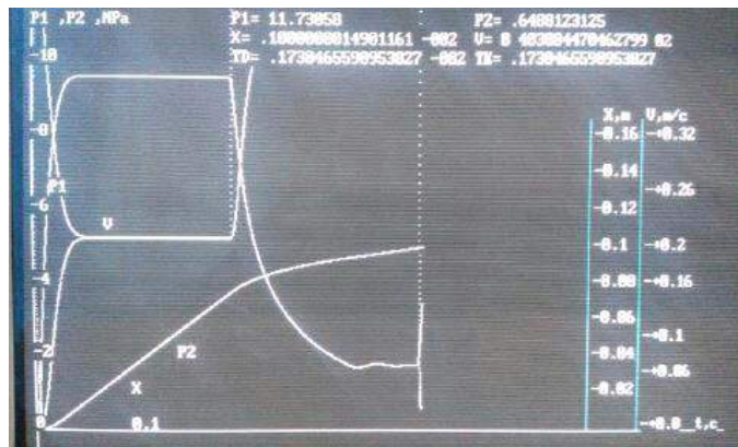
Рис. 2 – Графіки перехідного процесу гідроприводу з урахуванням стисливості рідини
