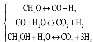
(дегідрування формальдегіду, конверсії CO та конверсії метанолу водяною парою до CO<sub>2</sub> та H<sub>2</sub>) залежно від параметрів (тиску, температури, складу вихідної суміші) процесу утилізації. При цьому необхідно розв'язати систему двох, або трьох (залежно від складу вихідного формаліну) алгебраїчних рівнянь. Для пошуку рішення був застосований ітераційний метод Хука-Дживса з урахуванням обмежень.
