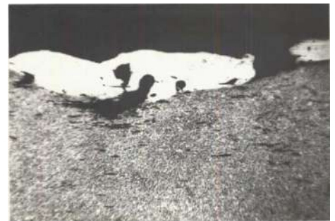
Рис. 1– Перенесення металу шліфованої деталі на металеву зв'язку круга
