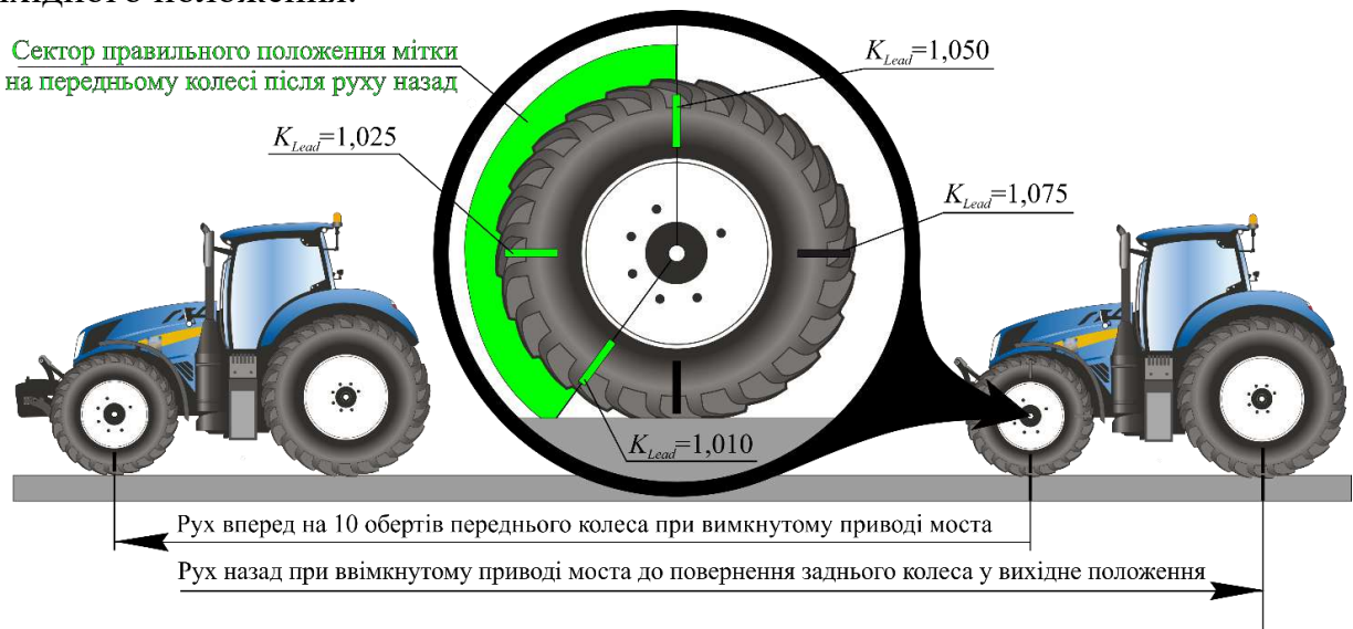
Схема для визначення забігання шин переднього моста
