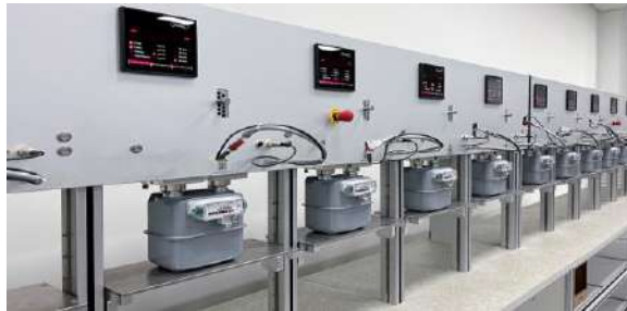
Рисунок 1 – Стенд для повірки газових лічильників
