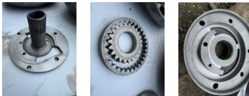
Рисунок 1 – Приклади відмов компонентів гідросистеми трансмісії виловних навантажувачів
