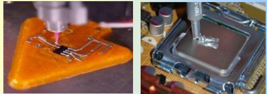
При нанесении электропроводящей пасты частицы металлического порошка заполняют впадины микронеровностей поверхности, способствуя увеличению площади фактического контакта и, соответственно, эффективной площади токопередачи. **В результате сопротивление контакта снижается и сохраняется стабильным в процессе эксплуатации.**
